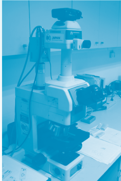
รูปที่ 3.4 แสดงกล้องจุลทรรศน์แบบเฟสคอนทราสต์ (Phase contrast microscope)
