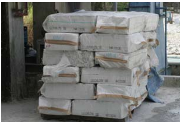
ภาพแสดงการเปิดถุงแร่ใยหินเพื่อรอกการนำเข้าเครื่องผสมบริเวณนอกอาคารโรงงาน
