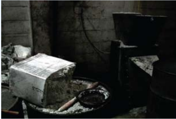
ภาพแสดงการเปิดถุงบรรจุแฉะไยหินโดยใช้วิธีการผ่ากลางถุง
