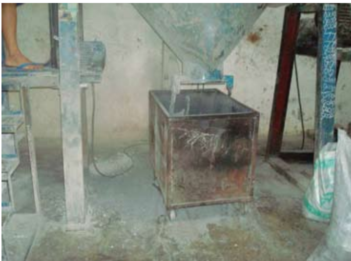
ภาพแสดงการเทวัตถุดิบออกจากถังผสม โดยไม่มีวัสดุปกคลุมเพื่อป้องกันการฟุ้งกระจาย
