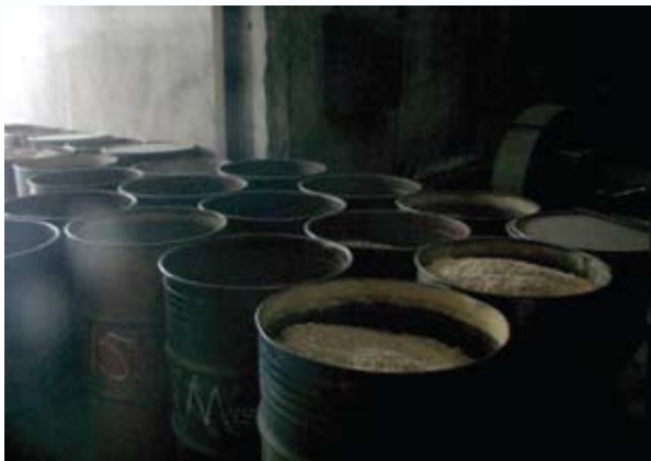
ภาพแสดงวัตถุดิบที่ผสมแล้วระหว่างรอการผลิตขั้นต่อไปโดยไม่ปิดฝาถังให้มิดชิด
