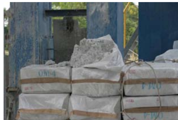
ภาพแสดงการเปิดถุงแร่ใยหินเพื่อรอกการนำเข้าเครื่องผสมบริเวณนอกอาคารโรงงาน
