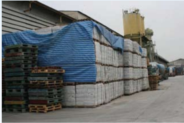
ภาพแสดงการจัดเก็บแร่ใยหินไม่เป็นระเบียบ และไม่จัดให้เป็นพื้นที่ควบคุม
