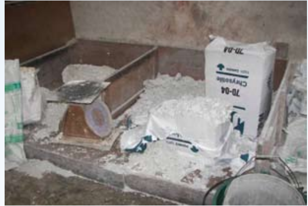
ภาพแสดงการเปิดถุงบรรจุแฉะไยหินโดยใช้วิธีการผ่ากลางถุง
