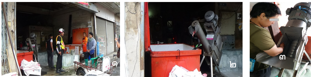
รูปที่ ๔ การเกิดอุบัติเหตุคนงานสัมผัสกับจุดบ่อน้ำแข็ง ทำให้มือขวาถูกฟันบดน้ำแข็งดึงเข้าไปในเครื่อง (๑.สภาพพื้นที่ที่เกิดอุบัติเหตุ ๒.เครื่องรดน้ำแข็งที่เกิดอุบัติเหตุ ๓. จุดบ่อนที่สามารถสัมผัสฟันบดน้ำแข็ง)
