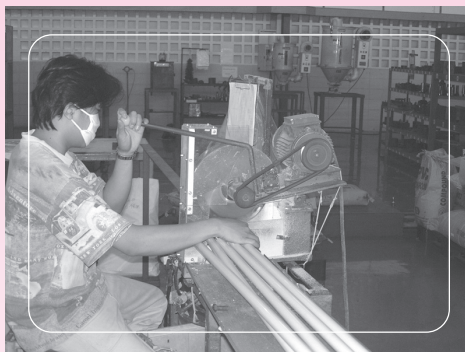
รูปที่ 3 การตัดท่อด้วยเลื่อยวงเดือน
