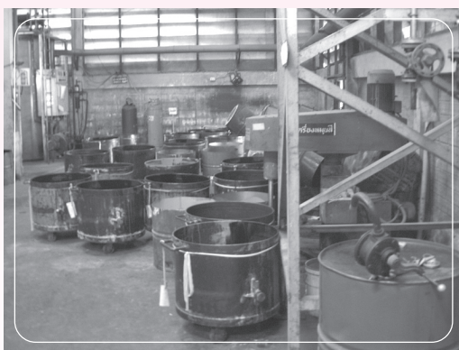
รูปที่ 12 ถังบรรจุสารเคมีที่ไม่มีฝาปิด
