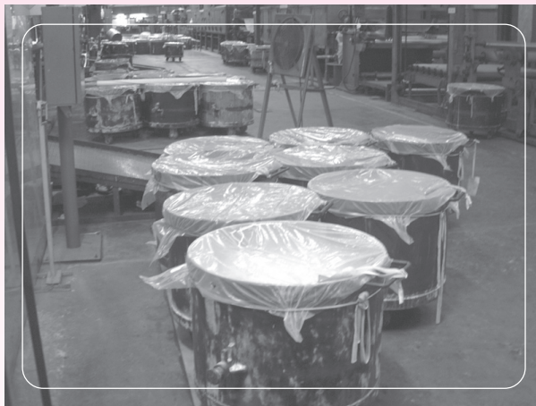
รูปที่ 17 ปิดปกคลุมถังบรรจุสารเคมีเพื่อป้องกันการฟุ้งกระจาย
