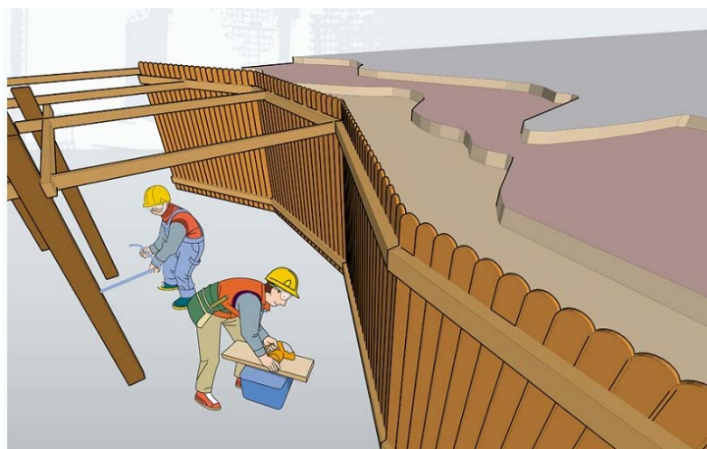
รูปที่ ๑๓ แสดงการป้องกันดินพังทลายโดยใช้กำแพงพืดพร้อมค้ำยัน (Sheet pile) (ที่มา : http://www.oshthai.org/index.php?option=com_k๒&view=item&id=๓๓๓๓ )
