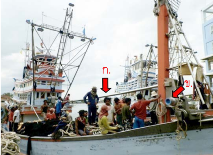
ภาพที่ ๒๒ ลักษณะของเรือประมงอวนดำที่ประกอบด้วยเสาขนานลำเรือ (ก) และก่วงหัวเรือ (ข)
