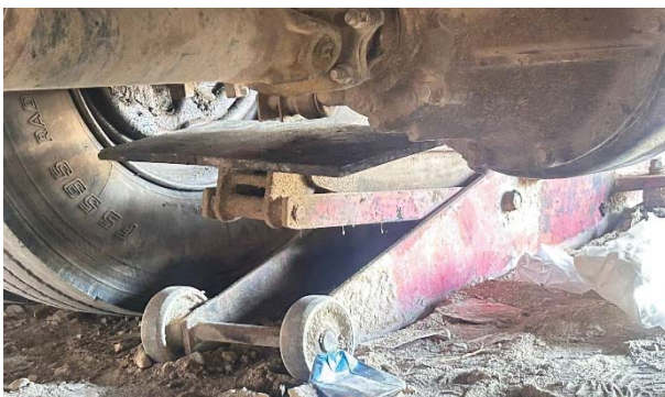
รูปภาพที่ ๕ แม่แรงตะเข้ยกบริเวณเสื่อเพลารถ
