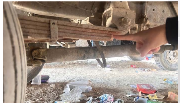
รูปภาพที่ ๖ หูแหนบที่ทับขาของลูกจ้าง
