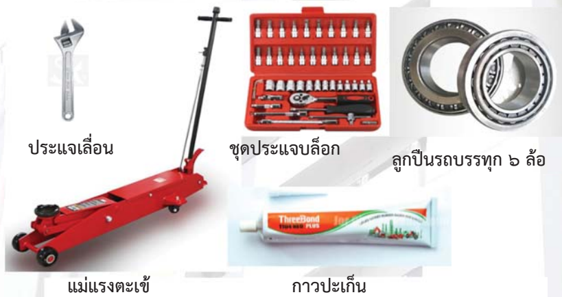
รูปภาพที่ ๒ วัสดุ อุปกรณ์ที่ใช้ในการเปลี่ยนลูกปืนล้อบรรทุก
