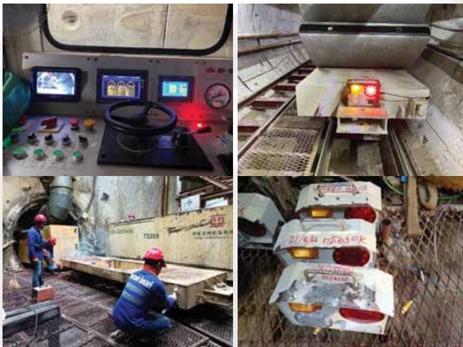
รูปที่ 1๙ การติดตั้งกล้องวงจรปิดบริเวณหน้าและหลังขบวนรถไฟทุกคัน
