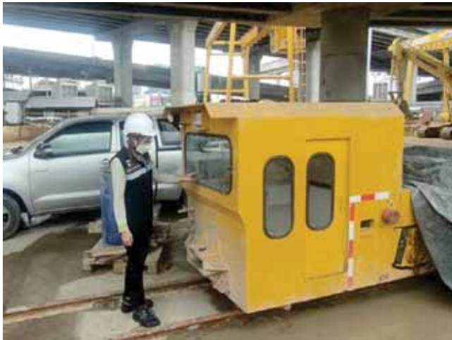
รูปที่ ๑๓ รถไฟ ใช้ในการขนส่งวัสดุและขุดดินที่ได้จากการขุด - เจาะ
