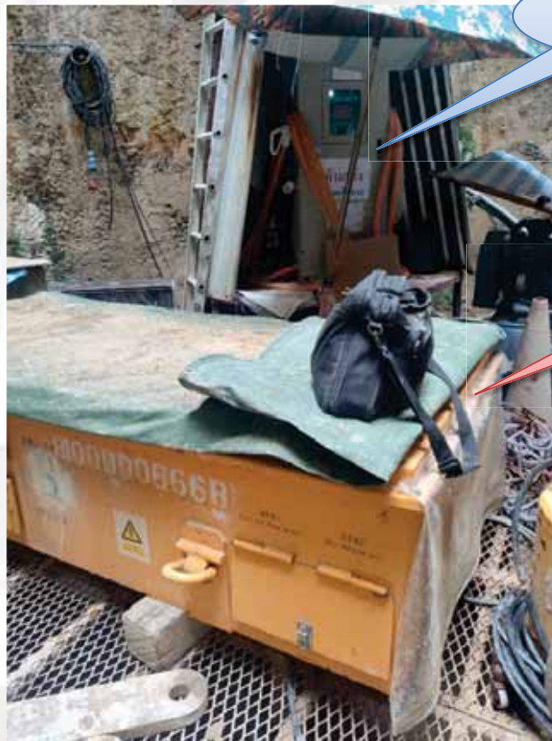
รูปที่ ๑๔ แบตเตอรี่สำรอง ไว้ใช้กับรถไฟ (สามารถใช้งานต่อเนื่องได้ประมาณ ๔ ชั่วโมง)
