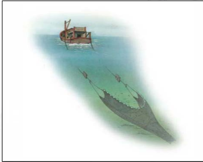
ลักษณะการทำงานของเรืออวนลากแผ่นตะเฆ่
