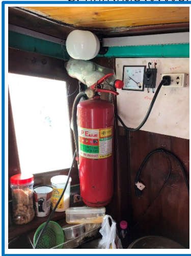
รูปภาพ : การติดตั้งถังดับเพลิงแบบเคลื่อนย้าย ขนาด ๑๕ ปอนด์ ประจำเรือ จำนวน ๓ ถัง
