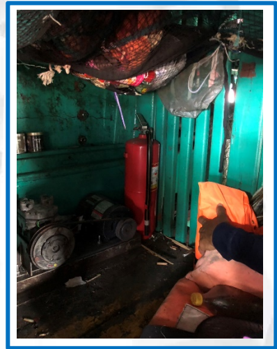
รูปภาพ : การติดตั้งถังดับเพลิงแบบเคลื่อนย้าย ขนาด ๑๕ ปอนด์ ประจำเรือ จำนวน ๓ ถัง
