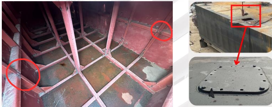
รูปที่ ๒๑ แสดงจุดที่ลูกจ้างพ่นสีบริเวณรอยเชื่อมภายในโป๊ะและปิดฝาเอาไว้
