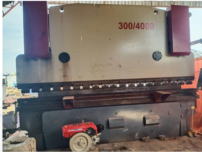
รูปที่ ๑๑ แสดงการพับเหล็กฉากเพื่อใช้ทำคานด้วยเครื่องพับเหล็ก
