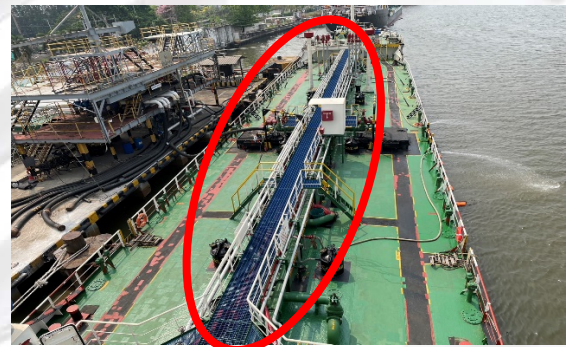
แนวท่อรับส่งสินค้า (น้ำมัน) บนพื้นที่ระวางบนเรือ
