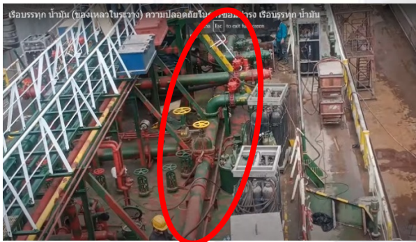
แนวท่อรับส่งสินค้า (น้ำมัน) บนพื้นที่ระวางบนเรือ
