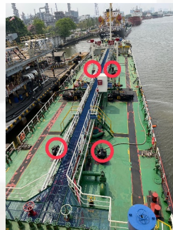
ข้อต่อวาล์วสำหรับรับส่งสินค้า (น้ำมัน)
