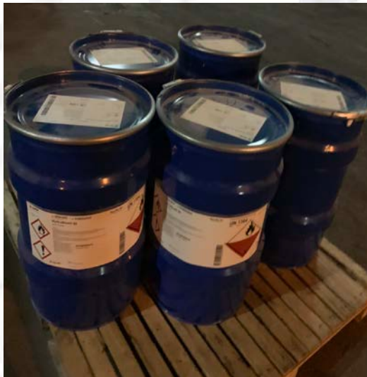
ถังสารเคมี โซเดียมไฮโดรซัลไฟต์ ( \text{Na}_2\text{S}_2\text{O}_4 ) ขนาด ๕๐ กิโลกรัม ที่ใช้ภายในบริษัท
