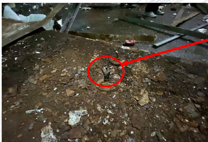
น๊อตที่แผ่น isowall คล้องกับสลิงค์โยงกับหลังคา ๔ จุด
