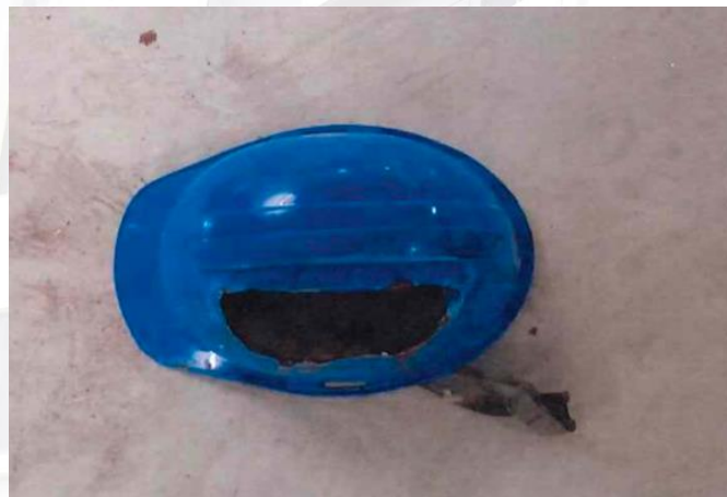
รูปแสดงความเสียหายของหมวกนิรภัยที่โดนเศษปูนหล่นกระแทก
