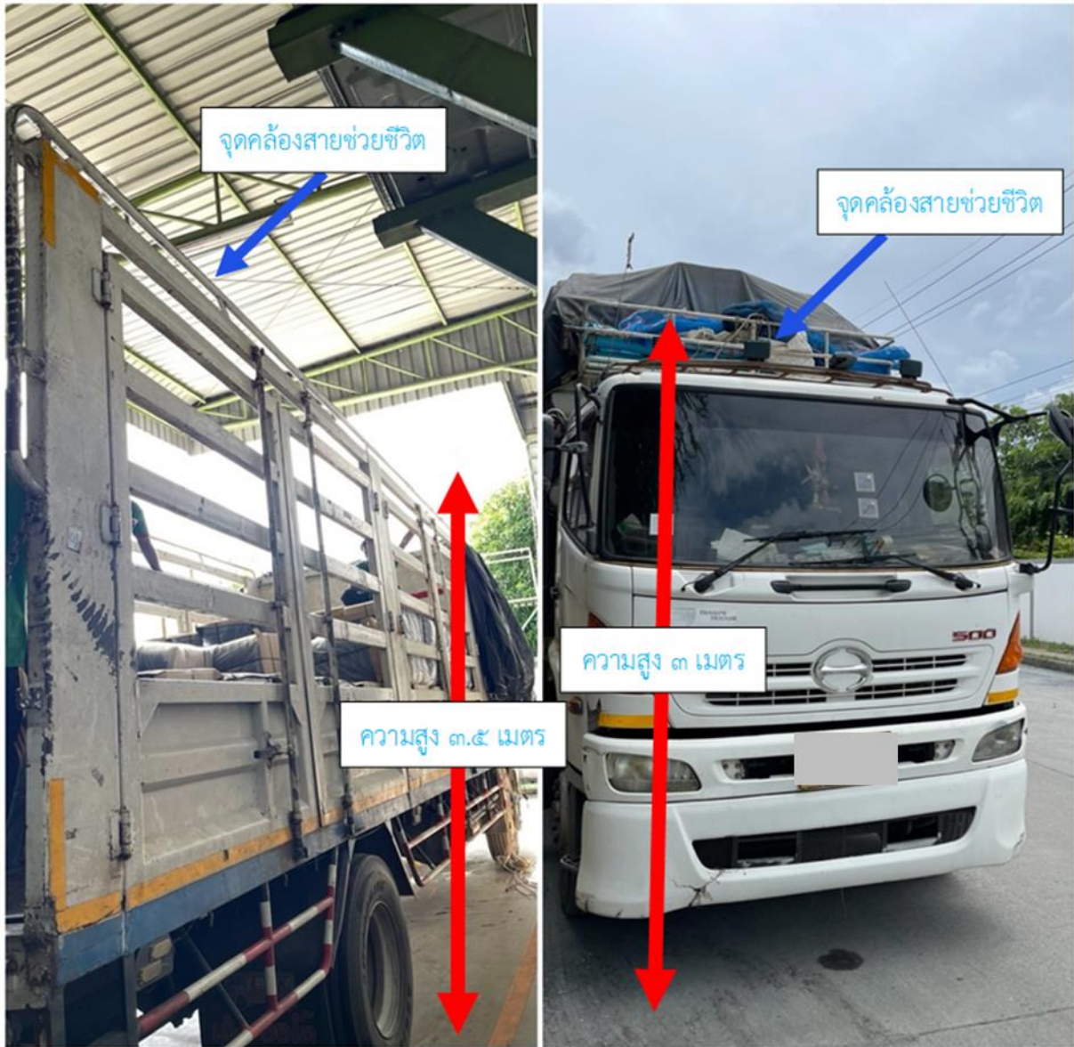
รูปภาพที่ ๕ บริเวณจุดที่คล้องสายช่วยชีวิตและระยะความสูงจากพื้น
