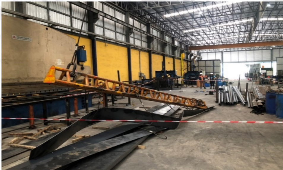
ภาพที่ ๔ ภาพจริงคานยกที่ใช้ยกแผ่นสลีป (แผ่นเหล็ก)
