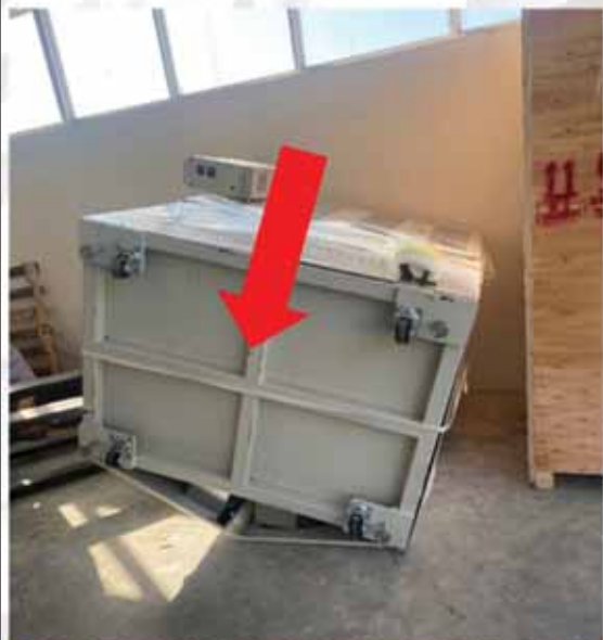
ใช้แชนด์ลิฟท์ไฟฟ้าเสียบเข้าที่ฐานรองของเครื่องจักรตามแนวลูกศร
