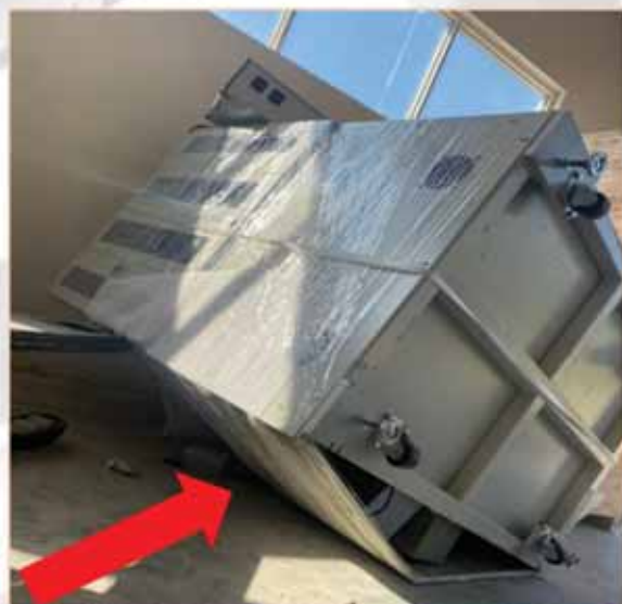
ฝั่งที่เครื่องจักรกระแทกนาย F และพยายามใช้แชนด์ลิฟท์ไฟฟ้ายกเครื่องจักรขึ้น เพื่อตั้งนาย F ออกมายังพื้นราบบริเวณลานโหลดสินค้า
