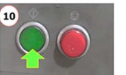
10 เหยียบสวิตซ์เท้าเพื่อล๊อคชิ้นงาน จากปุ่มกดปุ่ม Start
