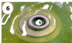
6 ชิ้นงานที่โหลดออกจาก OP10 โฟกัส นำยาหล่อเย็นทุกครั้งก่อนนำเข้า OP20
