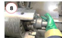
8 โหลดชิ้นงานเข้า Chuck jaw ที่สวางชิ้นงานต้องถูกต้องตาม รูป
