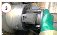
3 โหลดชิ้นงานเข้า Chuck jaw ที่สวางชิ้นงานต้องถูกต้องตาม รูป
