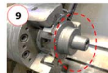
9 ตรวจสอบบริเวณชิ้นงานต้อง แนบกับ Chuck jaw
