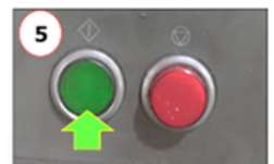
5 เหยียบสวิตซ์เท้าเพื่อล๊อคชิ้นงาน จากปุ่มกดปุ่ม Start
