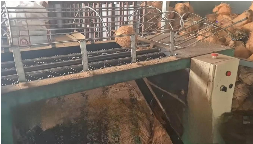
รูปภาพที่ ๓ เครื่องปอกใย/กากมะพร้าว (ที่เกิดอุบัติเหตุ)
