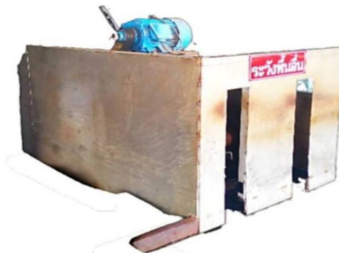
รูปภาพที่ ๔ ขั้นตอนการใช้เครื่องตัดน้ำแข็งซอง
