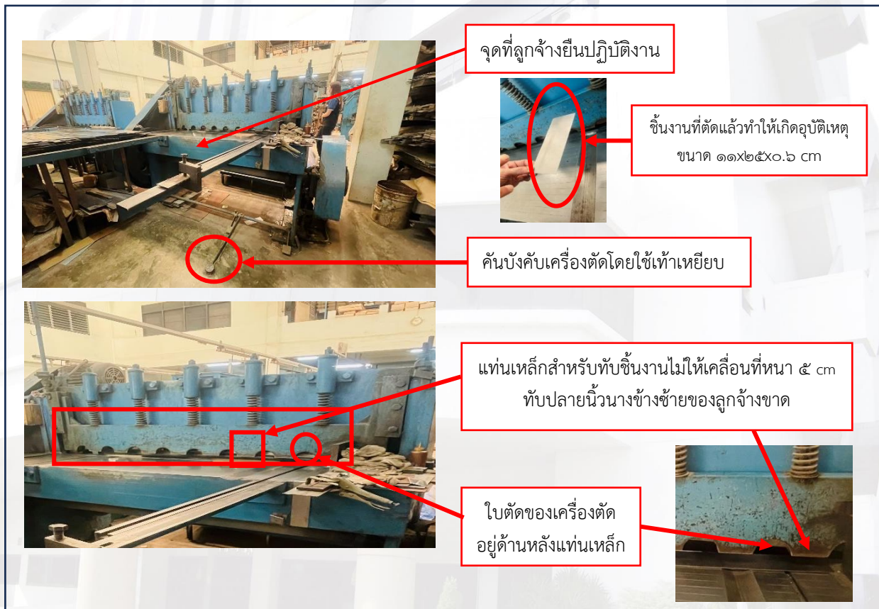
ภาพที่ ๑ บริเวณการทำงานกับเครื่องตัดที่ลูกจ้ำงเกิดอุบัติเหตุ
