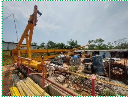
รูปภาพที่ ๔ ปันจันขาสูงชนิดเคลื่อนที่บนราง หรือ แกนดีครอน (Gantry Cranes) ล้มทับรถที่ลูกจ้างหลบฝนอนอยู่ เสียชีวิต ๓ ราย
