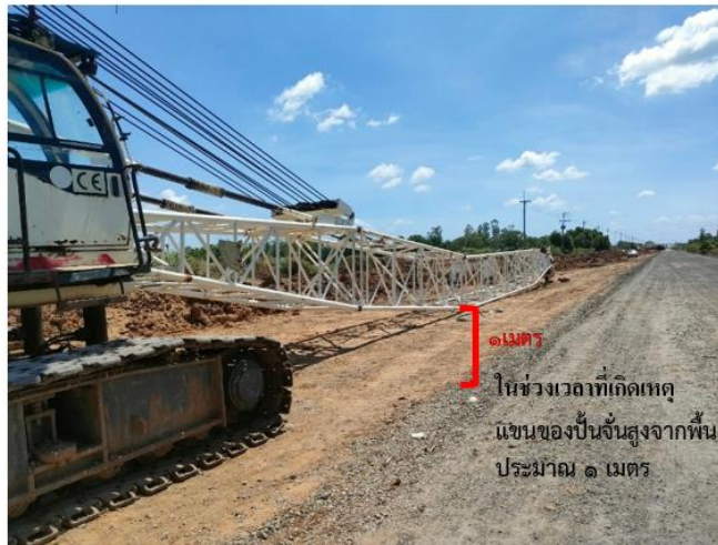
รูปภาพที่ ๑ แสดงบริเวณสถานที่เกิดเหตุลูกจ้งถูกแขนของปั้นจั่นทับ
