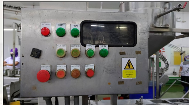
ภาพแสดงปุ่มควบคุมการทำงานของเครื่องจักร และปุ่มหยุดฉุกเฉิน
