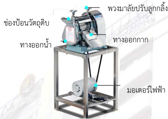
ภาพที่ ๓ องค์ประกอบเครื่องคั้นน้ำมะนาว C.H.H. (ที่มา: ร้านวิทวัส https://www.vittavat.com/ )
