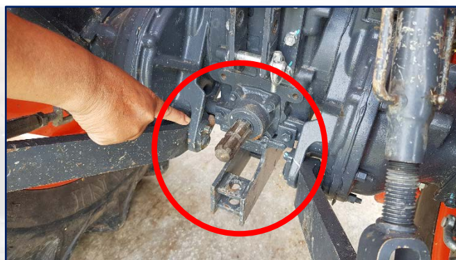
รูปภาพที่ ๕ เพลลาของรถแทรกเตอร์ที่นำเครื่องบดย่อยมาต่อพ่วง
