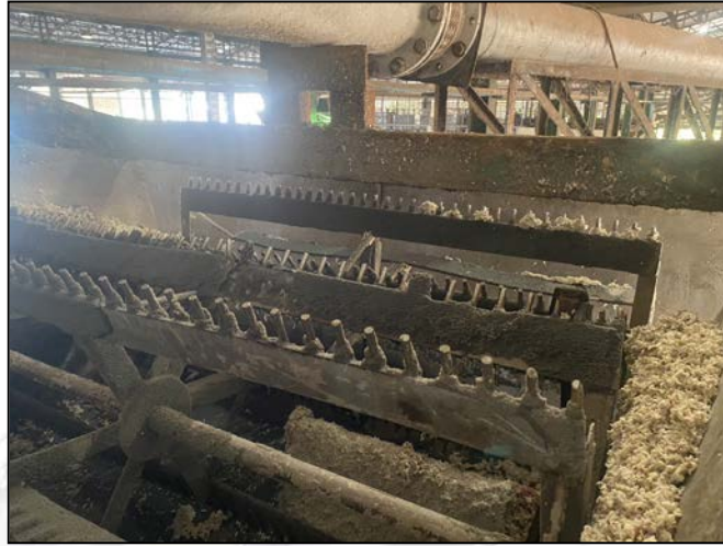
รูปภาพที่ ๓ ลักษณะใบพัดของเครื่องโรยยาง
