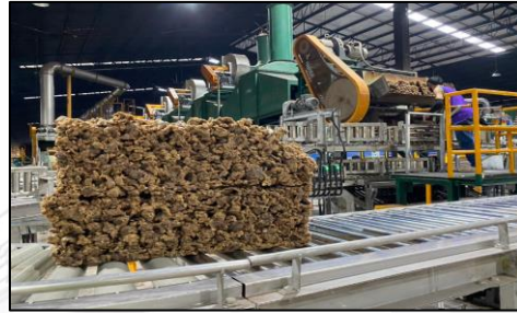
รูปภาพ : เครื่อง Cooling chain ภายในมีพัดลมทำหน้าที่ในการดูดและเป่าให้แห้งเย็น และลำเลียงออกมาเป็นผลิตภัณฑ์เพื่อเข้าสู่การ Packing
