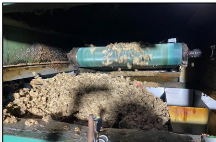
รูปภาพ : เครื่อง PZ สับละเอียด และลำเลียงจากสายพานเข้า Cooling fan เพื่อเข้าสู่การอัดก้อน
