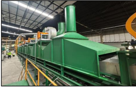
รูปภาพ : เครื่อง Cooling chain ภายในมีพัดลมทำหน้าที่ในการดูดและเป่าให้แห้งเย็น และลำเลียงออกมาเป็นผลิตภัณฑ์เพื่อเข้าสู่การ Packing
