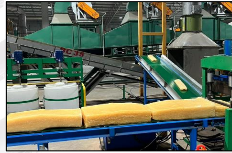
รูปภาพ : กระบวนการลำเลียงยางพาราผสมกับผลิตภัณฑ์ยางเหลือง
