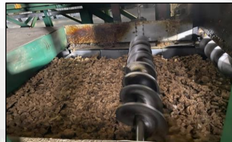
รูปภาพ : เครื่อง PZ สับละเอียด และลำเลียงจากสายพานเข้า Cooling fan เพื่อเข้าสู่การอัดก้อน
