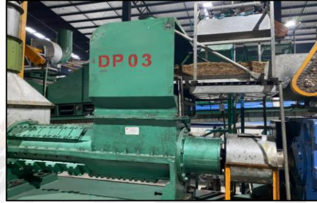
รูปภาพ : เครื่อง DP สำหรับสับย่อยยางพาราที่ฟุ้งออกจากเตาอบ
