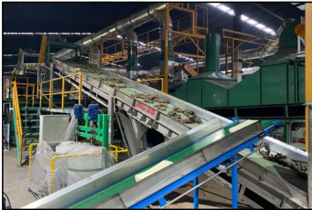
รูปภาพ : กระบวนการลำเลียงยางพาราผสมกับผลิตภัณฑ์ยางเหลือง
