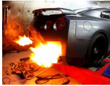
รูปที่ ๑๖ แสดงตัวอย่างการเกิดระเบิดย้อนหรือแบคไฟร์ (Back Fire)
