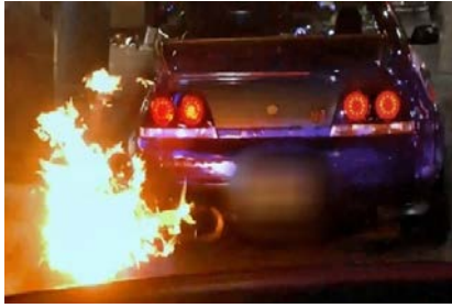
รูปที่ ๑๖ แสดงตัวอย่างการเกิดระเบิดย้อนหรือแบคไฟร์ (Back Fire)
