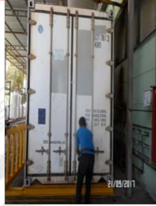
รูปที่ ๑๑ แสดงการปิดและล็อกประตูตู้คอนเทนเนอร์
